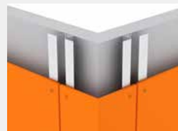
Élément d'angle sur tasseaux métalliques.
